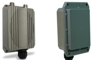
**PheeNet AP-15814N \ AP-15802N** - уличная WiFi точка доступа стандарта 802.11n с двумя встроенными (для AP-15814N) или внешними (для AP-15802N) антеннами (2x2 MIMO) работает в диапазоне 5GHz и обеспечивает скорость передачи до 300Mbps. AP-15814N \ AP-15802N имеет мощность передатчика 500mW, что позволяет ей обеспечивать большую зону покрытия в режиме точки доступа или увеличенную дистанцию передачи в режиме моста.
