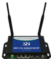
**PheeNet AP-854NP** - универсальная WiFi точка доступа (стандарт 802.11n) промышленного исполнения для использования внутри помещений. Металлический корпус стандарта IP50, 2 внешние антенны, мощность передатчика 100mW и поддержка PoE IEEE802.3af (48V) делают эту точку идеальным решением для промышленных помещений, складов и фабрик.
