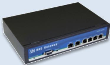
**PheeNet WMS-308N** контроллер точек доступа WiFi является центром управления беспроводной сети, одновременно сочетает в себе IP-маршрутизатор / Firewall / Multi- WAN / QoS, а так же AAA шлюз (Authentication, Authorization, Accounting). Контроллер WMS-308N создан для быстрого развертывания и обеспечения надежной работы защищённых Wi-Fi сетей средних и крупных предприятий, складов, офисов, гостиниц и торговых центров.
